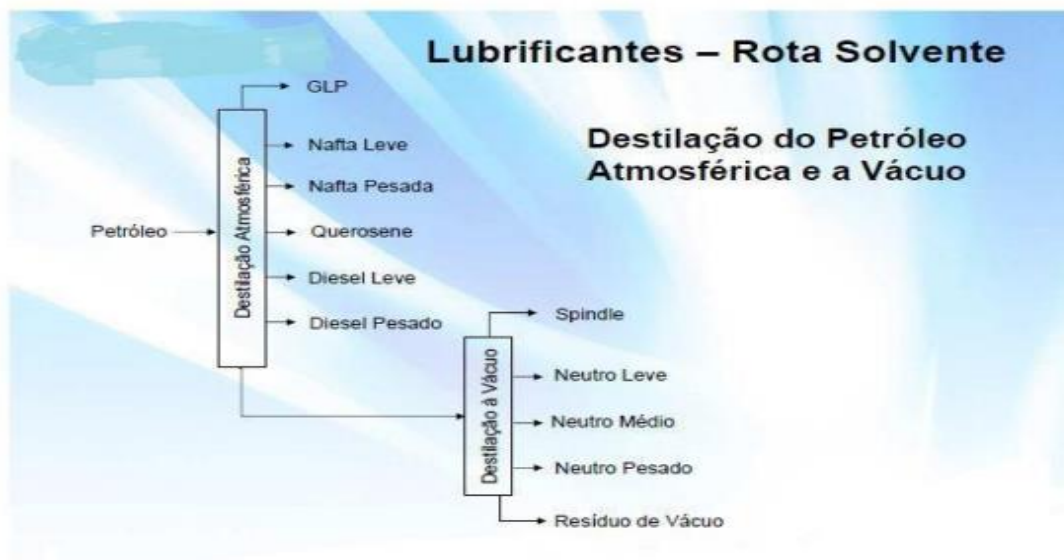
Figura 2. Esquema da destilação atmosférica e a vácuo (8).
