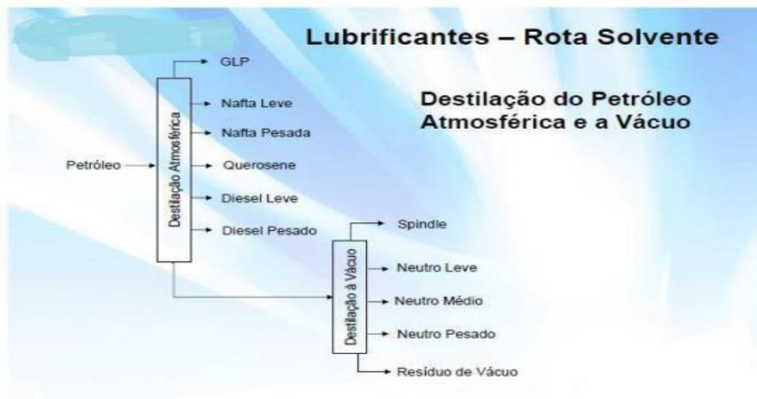
Figura 2. Esquema da destilação atmosférica e a vácuo (8).
